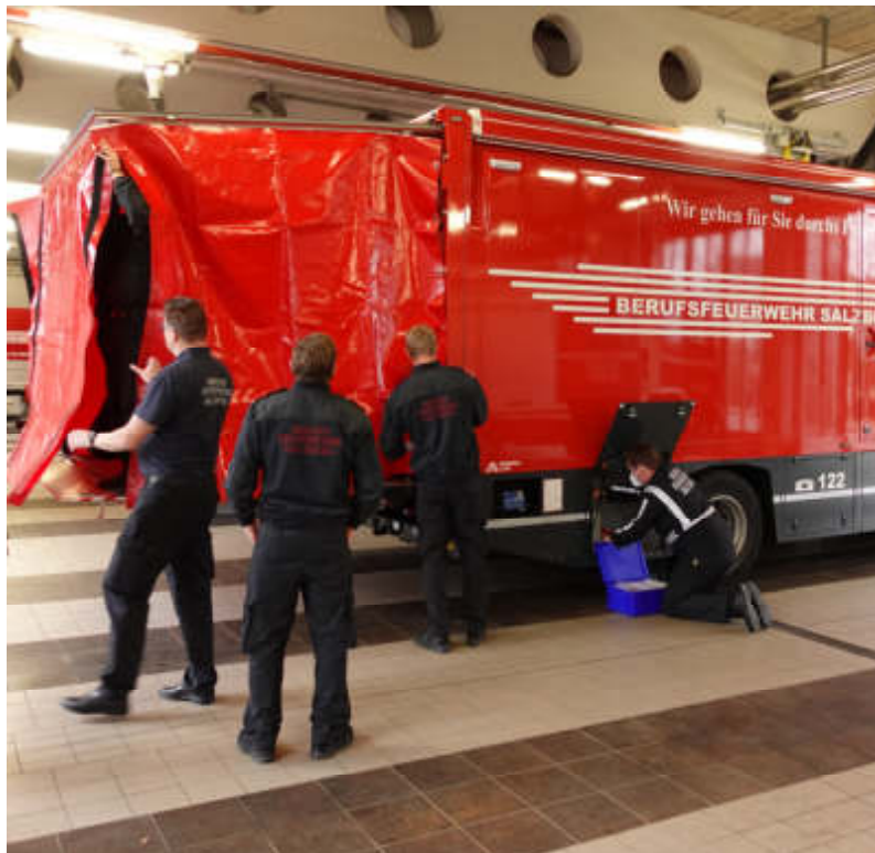
Montierte Witterungsschutzplanen am Fahrzeugheck
