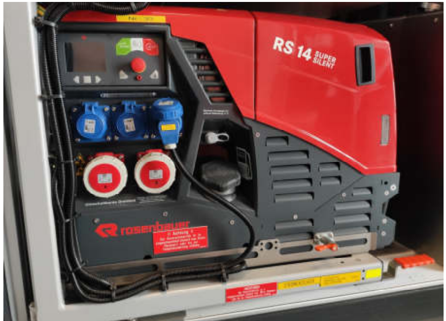
Dreh- und Wechselstromerzeuger der Type RS 14 mit einer Leistung von 13,6 kVA
