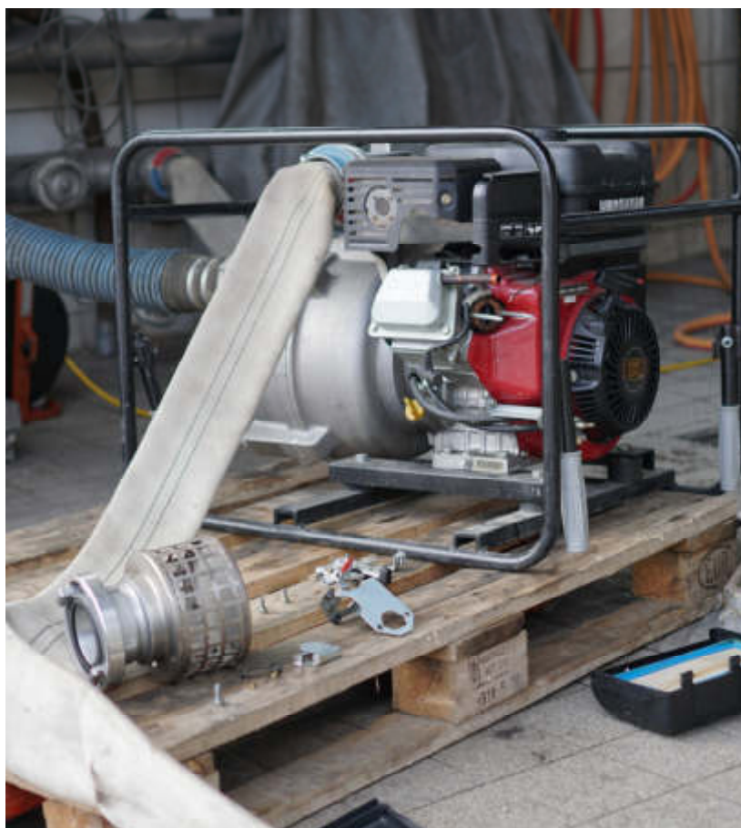
Leistungstest einer Feuerweerpumpe am Prüfstand: nötigenfalls werden Verschleißteile ausgetauscht
