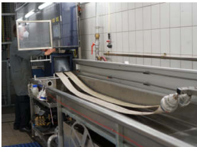
Die vollautomatische Schlauchpflege- und -prüfstraße der Hauptfeuerwache Maxglan
