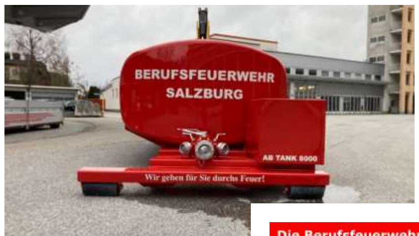
Schlauchanschlüsse am Heck
