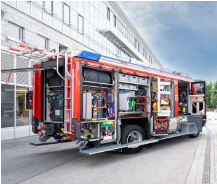
Beladeräume mit Ausrüstung
