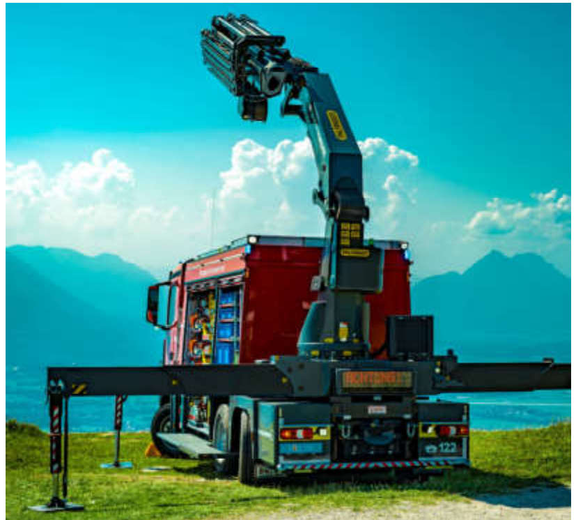
Schweres Rüstfahrzeug „SRF-K“: Mercedes Benz Arocs 2546 6x2 mit Ladekran Palfinger PK 42.002 SH G
