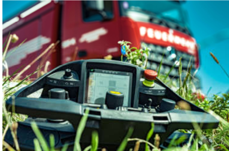
Funkfernbedienung zum Steuern des Ladekranes vom Typ Palfinger PK 42.002 SH G
